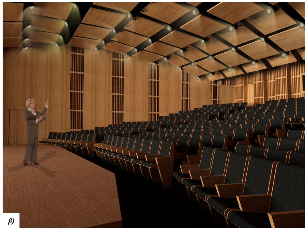
Σχήμα 5.3 Ακαδημία παραστατικών τεχνών στην Αθήνα. Έτος 2015, \approx 300 άτομα. α) Αίθουσα μουσικών εκδηλώσεων, β) Αίθουσα θεάτρου / διαλέξεων. (Παπαιωάνου & Μονγκάση, 2015· Sotiropoulou et al., 2015). Ευέλικτα «modules» απαρτίζουν τις παρειές της αίθουσας με επιλέξιμη είτε την ηχοαπορροφητική είτε την ηχοανακλαστική / ηχοδιαχυτική όψη των, αναλόγως του ακροάματος. Όταν ανοίγει η εσοχή της ορχήστρας ο extra όγκος συμβάλλει στην αύξηση του χρόνου αντήχησης. RT_{mid, min/max} = 1.00 / 1.50 s (με ακροατήριο).
