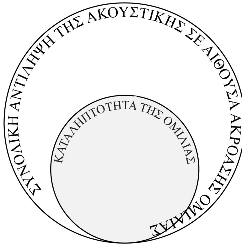
Σχήμα 3.1 Η καταληπτότητα της ομιλίας, ως (σημαντική) συνιστώσα της συνολικής αντίληψης της ακουστικής σε αίθουσες ακρόασης ομιλίας. Υπάρχουν και άλλες (λιγότερο διερευνημένες) συνιστώσες.
