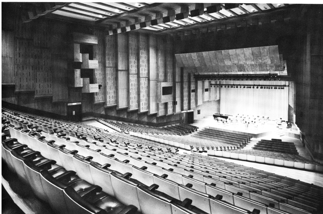
Σχήμα 4.33 Queen Elizabeth Hall, Λονδίνο Έτος 1967, \approx 1100 άτομα. Αρχ/των: Greater London Council. Εσωτερική Αποψη (© Barron, 1993). ΑΒΑΘΕΙΣ ΟΔΟΝΤΩΣΕΙΣ (0.40 m) ανά 1.70 m στις πλευρικές παρειές, προκαλούν διάχυση γύρω στο 1 kHz. ΣΧΙΣΜΕΣ εύρους 8.0 cm επί της οδοντωτής παρειάς εμπλουτίζουν τη διάχυση στα 4 kHz.
