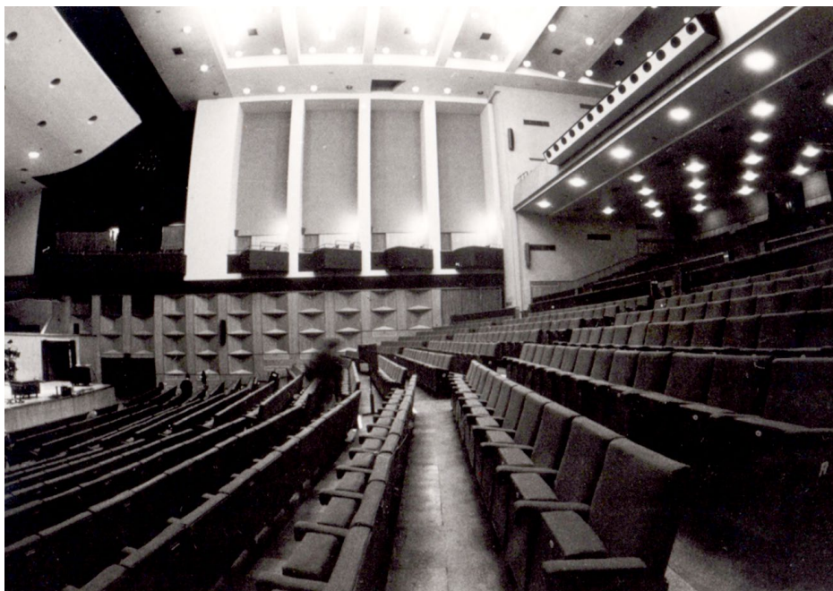
Σχήμα 4.35 Fairfield Hall, Croydon, Λονδίνο. Έτος 1962, \approx 1750 άτομα. Αρχ/των: R. Atkinson and Partners, Σύμβ. ακουστικής: H. Bagenal. Εσωτερική άποψη. Την οροφή διασχίζουν εγκαρσίως δοκοί αβαθείς (0.75 m) ανά 2.50 m.
